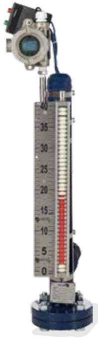
Los indicadores de nivel tipo magnético operan con el principio de vasos comunicantes con una pierna o cámara de material antimagnético que se coloca por la parte exterior del tanque.
